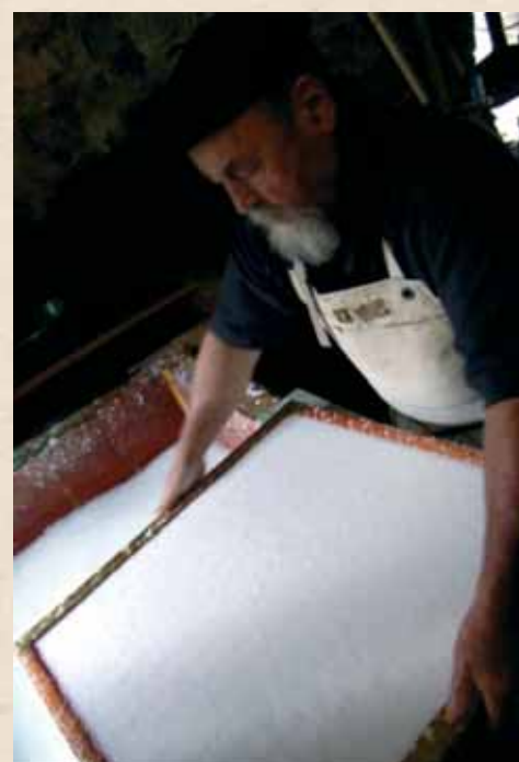
La pâte à papier est puisée à l'aide d'un tamis
