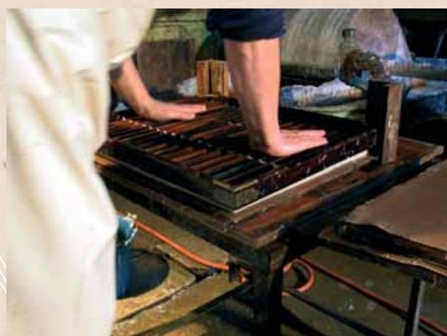
La feuille de papier est placée sous presse pour extraire l'eau.
