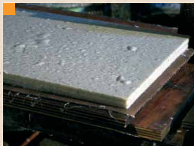
La feuille de papier est retirée du tamis, puis couchée sur un feutre.
